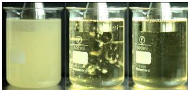
Limpieza de un vaso con diferentes sustancias que causan turbidez mediante ultrasonidos.
