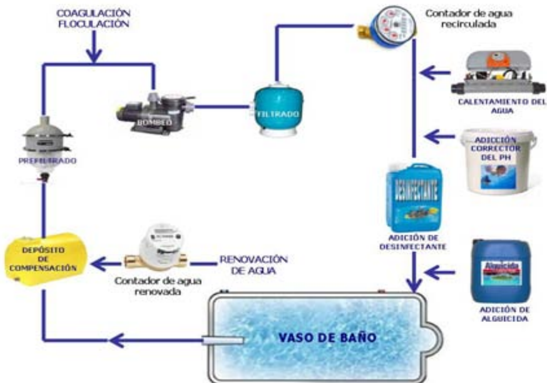
EJEMPLO DE UN PLAN DE TRATAMIENTO DE UN VASO DE PISCINA
