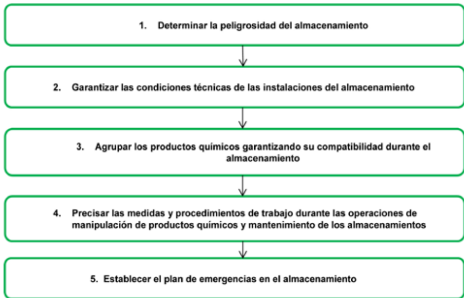
Figura 1. Puntos críticos para garantizar la seguridad en el almacenamiento de productos químicos
