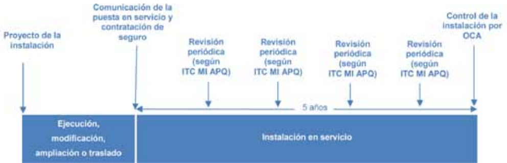
Figura 4. Obligaciones generales del titular de la instalación
