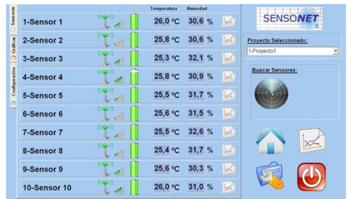
Captura de pantalla de SENSOKIT con ejemplo de proyecto con diez sensores. El nombre de proyecto y el nombre de los sensores se pueden configurar al crear el proyecto en cuestión.
